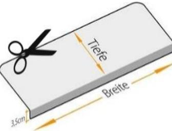
**\*Bitte mit beachten! Durch das Einkleben des Treppenkantenwinkels verkürzt sich die Auftrittsfläche um die Winkelhöhe!**
